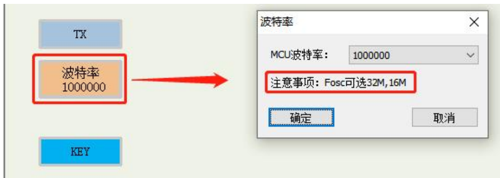
图2-4 触摸调试波特率配置
