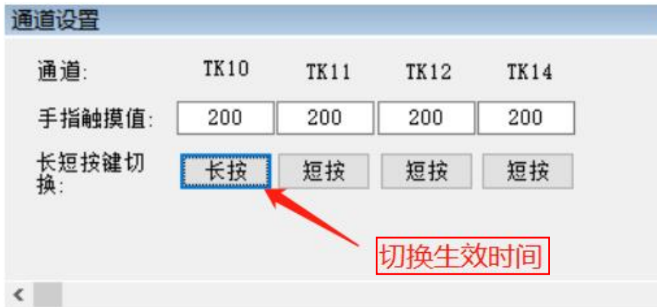
图4-11 触摸通道手指触摸值及生效时间
